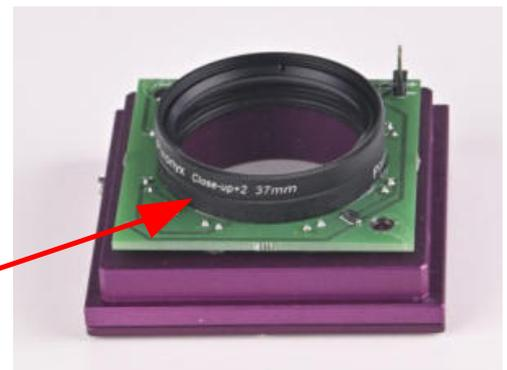
Nun können Sie die Nahlinsen (close up lens) entsprechend der Objektentfernung einschrauben, in dem Sie die Nahlinsen je nach Entfernung verwenden.
